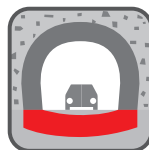
トンネル (インバート設置)
