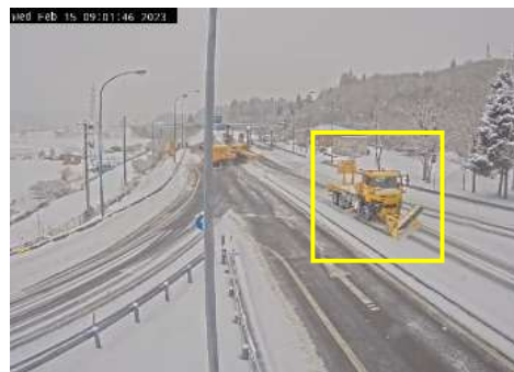
ONランプを順走する除雪車両に反応して誤検知
