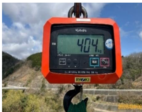
写真2：実重量管理(クレーンスケールによる計量)
